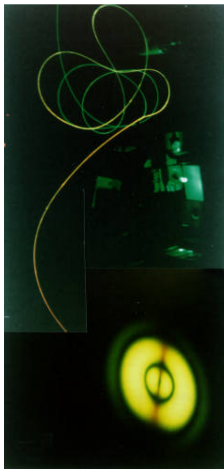
Fig. 12. Photographie en champ lointain de la lumière collectée à la sortie de la fibre.
